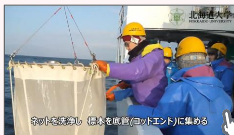
ネットを洗浄し 標本を底管(コッドエンド)に集める
